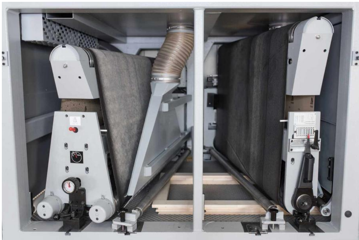
Slika 6 Širokotračna brusilica Kundig sa brusnim trakama postavljanim u "V" oblik (kundig.com)
