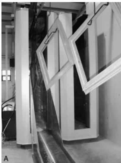
Slika 11 Nanošenje oblijevanjem (Bulian i Graystone, 2009.)
