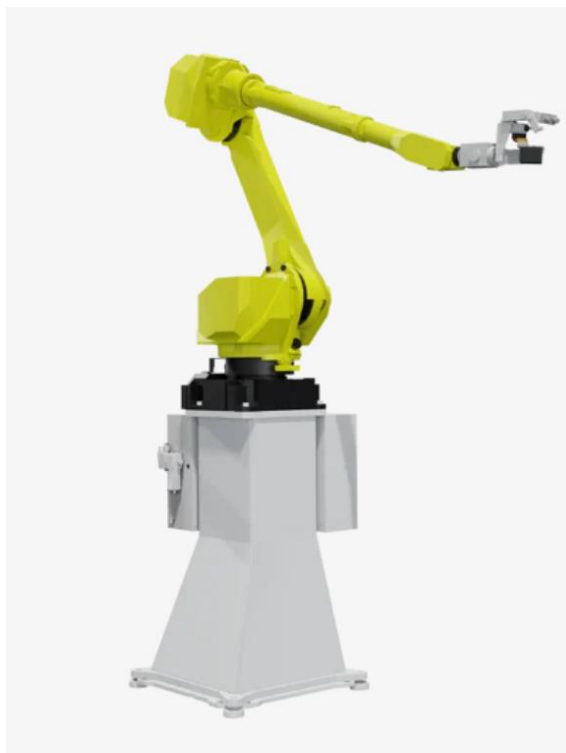
Slika 13 Robot za štrcanje (www.cefla finishing.com)
