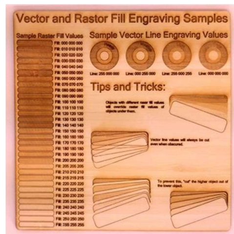
Slika 8. Prikaz vektorskog i rasterskog graviranja
