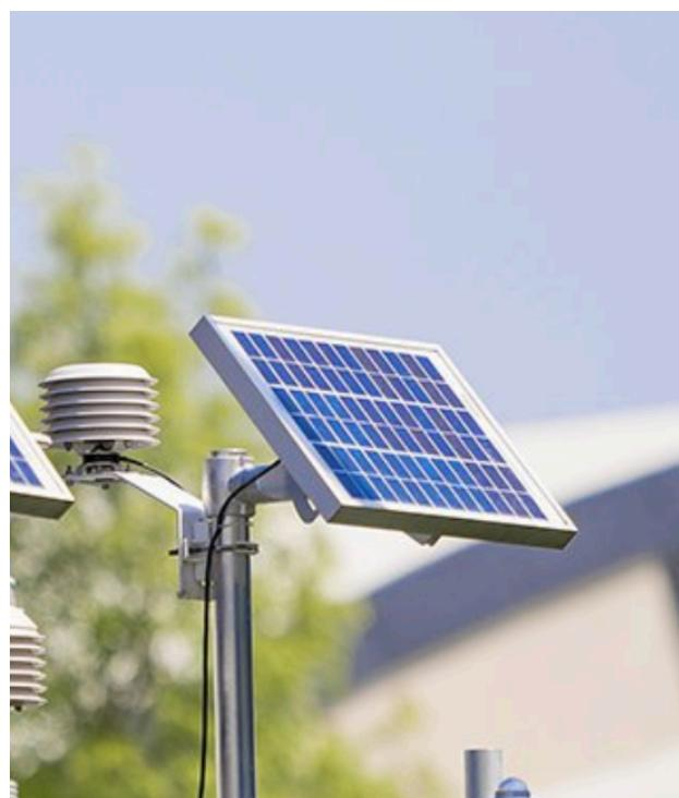
Slika 19. solarni panel (izvor el.energije)
