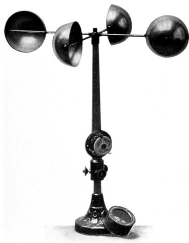
Slika 7. Robinsonov anemometar (lopatasti)
