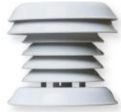
Slika 5 higrometar sa zaštitom
