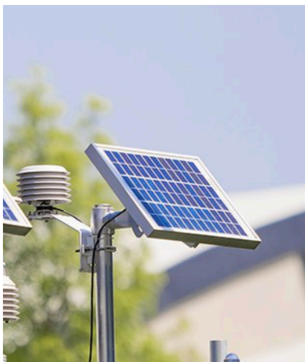
Slika 19. solarni panel (izvor el.energije)
