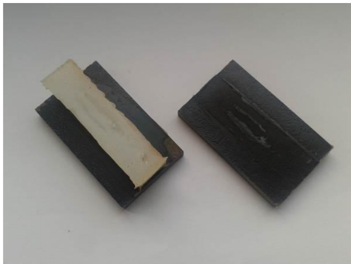
Slika 10. Uzorak Lukopren UNI N nakon ispitivanja (Izvor: Liška i sur., 2015)
