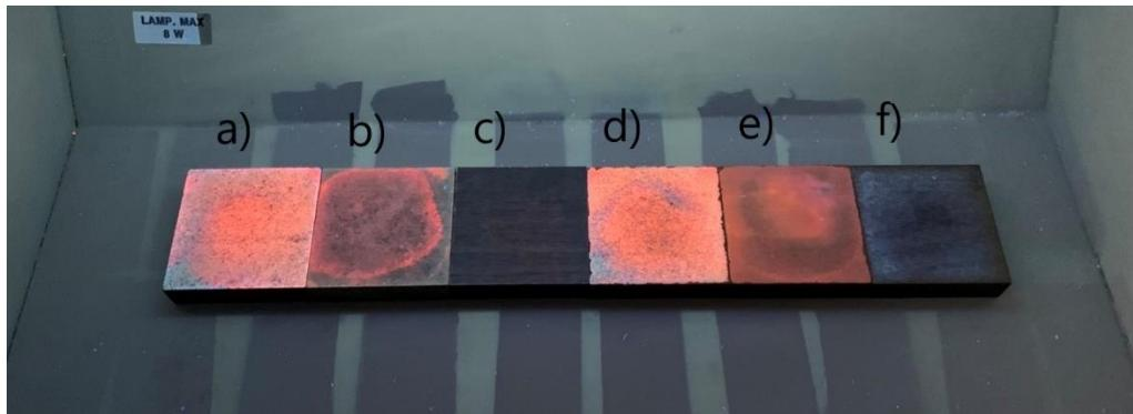
**Slika 35.** Uzorci Compact ploča s dekorom hrasta: a) uzorak tretiran nitratnom kiselinom 2 sata, b) uzorak tretiran sulfatnom kiselinom 2 sata, c) uzorak tretiran sanitарom 24 sata, d) uzorak tretiran nitratnom kiselinom 24 sata, e) uzorak tretiran sulfatnom kiselinom 24 sata i f) uzorak tretiran solnom kiselinom 24 sata
