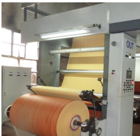
Slika 3. Proces impregnacije melamin formaldehidnom smolom dekorativnih listova HPL-a (Izvor: kiaansanat.com ; pristupljeno: 10.9.2023.)
