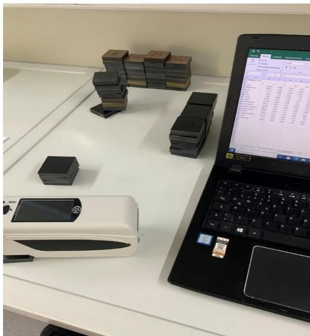
Slika 20. Mjerenje promjene boje kolorimetrom
