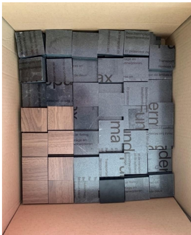
Slika 17. Dvije vrste uzoraka korištene za analizu otpornosti Compact ploča na djelovanje kemikalija (crni dekor i dekor hrasta)
