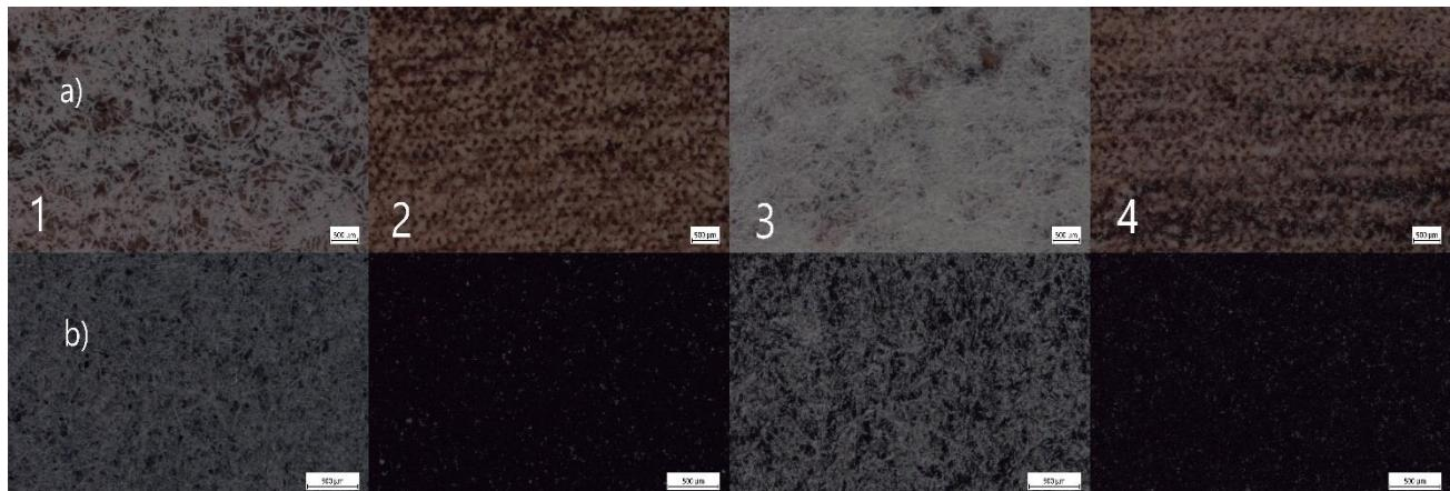
**Slika 30.** Usporedba površine tretiranih uzoraka Compact ploče kiselinom kroz 2 sata
