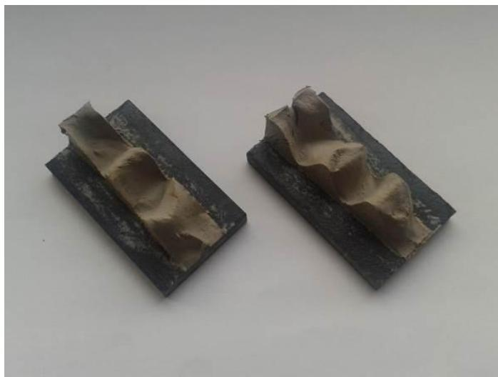
**Slika 11.** Uzorak SOUDASEAL 215LM nakon ispitivanja (Izvor: Liškaa i sur., 2015)
