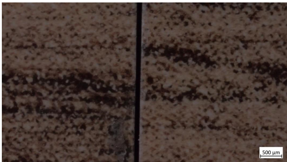
Slika 32. Usporedba površine ne tretiranog (lijevo) i uzorka tretiranog čajem (desno)
