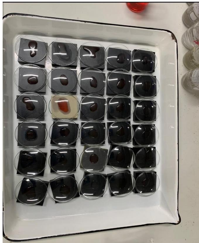
**Slika 21.** 10-minutni test tvrdoće površine otopinom klorovodične kiselina (4N)
