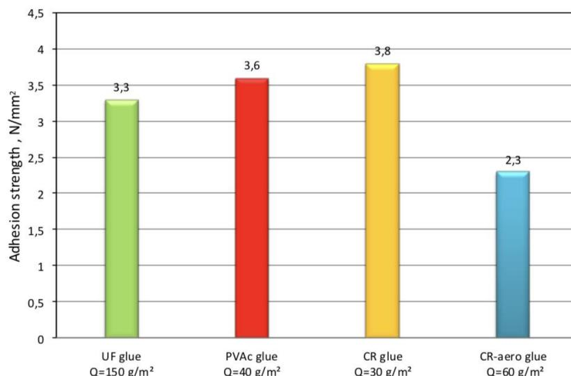
**Slika 5.** Adhezijska čvrstoća ljepljenih spojeva ploče iverice i HPL (Izvor: Angelski i Mihailov, 2017)
