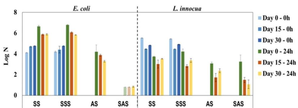
**Slika 16.** Antimikrobna svojstva PHMB-HPL proizvedenih dvjema različitim metodama, testiranim protiv *E. coli* i *L. innocua* tijekom razdoblja od 30 dana simulirajući dnevnu upotrebu (Izvor: Magina i sur., 2016)
