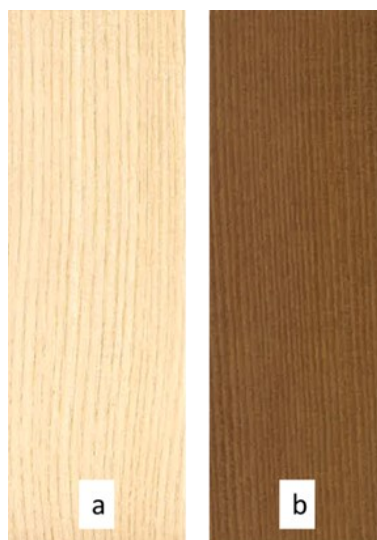
Slika 2. Uzorak nemodificirane (a) i toplinski modificirane (b) jasenovine
