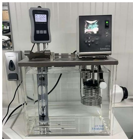
**Slika 2.** Termostat, viskozimetar i digitalni mjerač vremena Visco Clock plus
