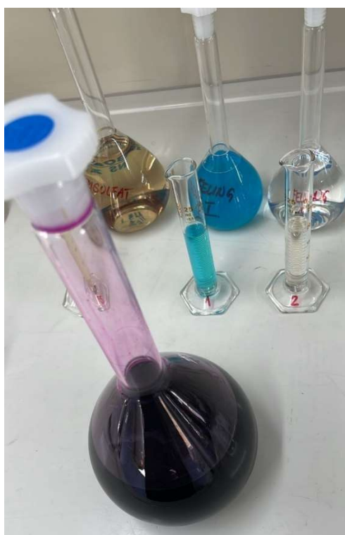
Slika 10. Kemikalije korištene za određivanje bakrovog broja
