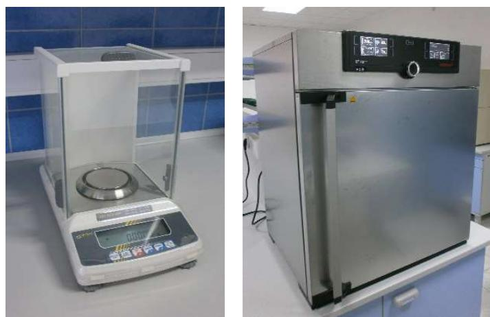
**Slika 11.** Analitička vaga Kern ABT 220-4M i laboratorijski sušionik Memmert UF110 plus
