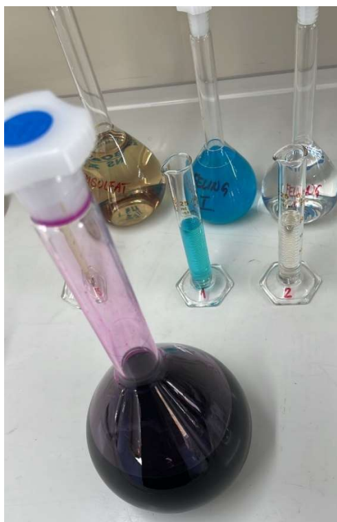
Slika 10. Kemikalije korištene za određivanje bakrovog broja
