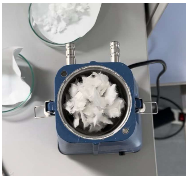
Slika 9. Mlin za dobivanje vatastog materijala
