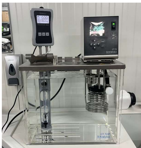
Slika 2. Termostat, viskozimetar i digitalni mjerac vremena Visco Clock plus (Foto: Žutić, 2023)
