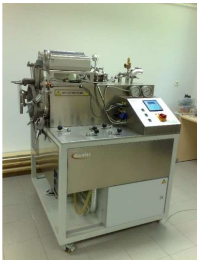
Slika 4. Laboratorijska mini impregnacijska komora (Izvor: Katalog opreme Šumarskog fakulteta, 2014)
