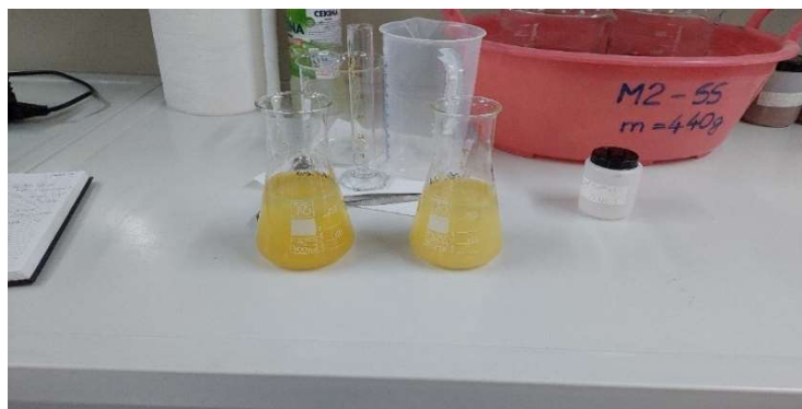
Slika 7. Erlenmeyerove tikvice sa sirovinom i mješavinom kemikalija za izbjeljivanje
