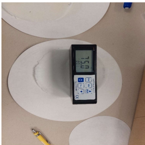
Slika 18. Mjerač bjeline PCE-WNM 100
