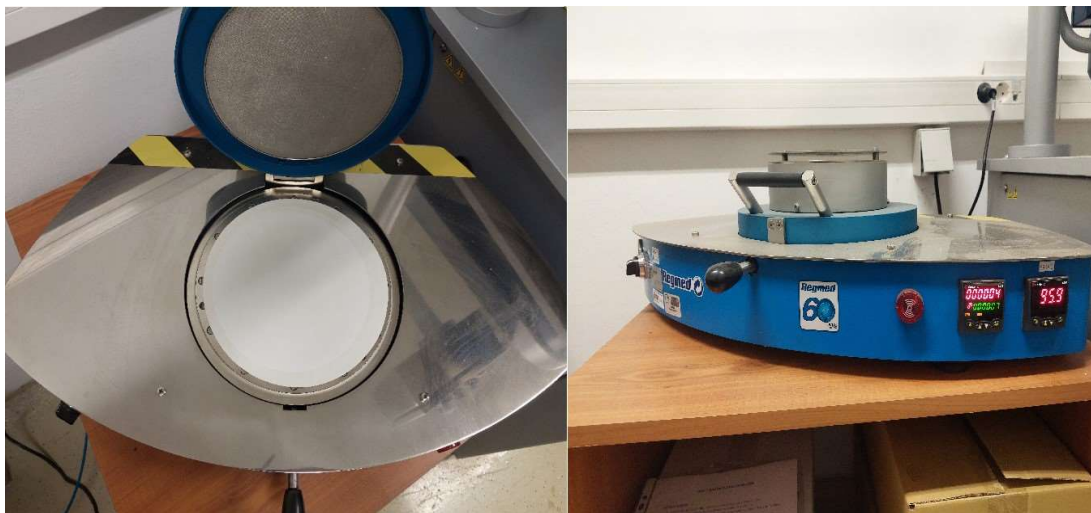
Slika 17. Sušač laboratorijskih listova REGMED TD-RK
