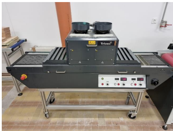
Slika 6. Stroj za sušenje premaza Trivec.
