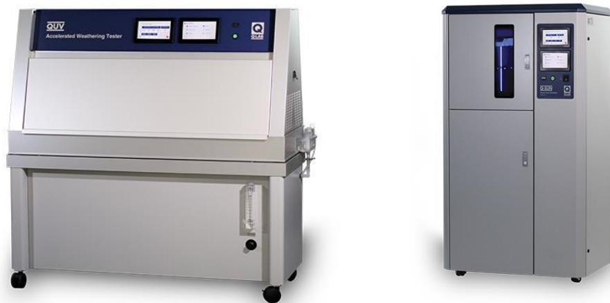
Slika 9. Prikaz uređaja za ubrzano umjetno izlaganje simulacijom stvarnih uvjeta: QUV uređaj (liejvo) i Xenon Test komora (desno) (Izvor: <https://www.q-lab.com/products/> (Pristupljeno: 23. 9. 2023.))
