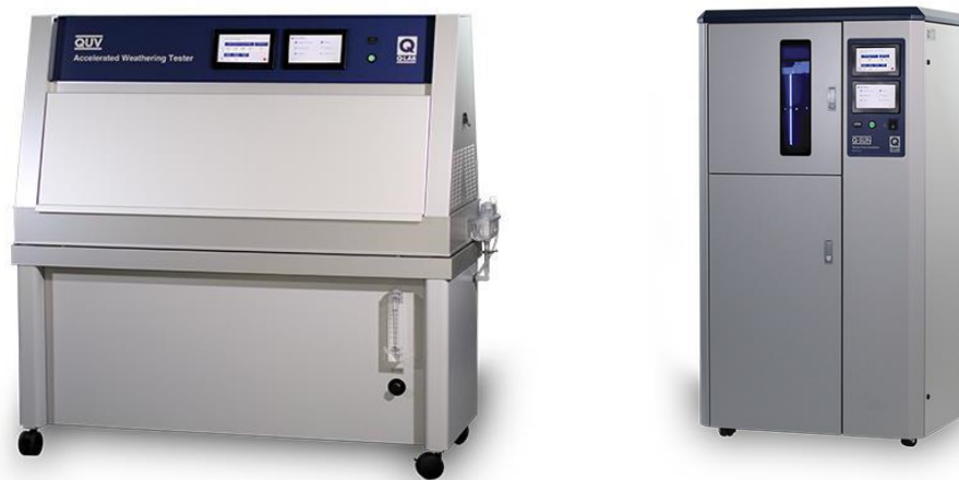
Slika 9. Prikaz uređaja za ubrzano umjetno izlaganje simulacijom stvarnih uvjeta: QUV uređaj (lijevo) i Xenon Test komora (desno) (Izvor: https://www.q-lab.com/products/ (Pristupljeno: 23. 9. 2023.))
