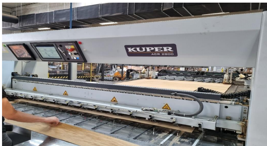
Slika 18. Stroj za spajanje furnira
