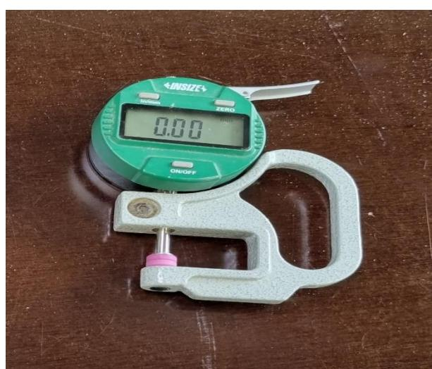
Slika 7a. Mikrometar
