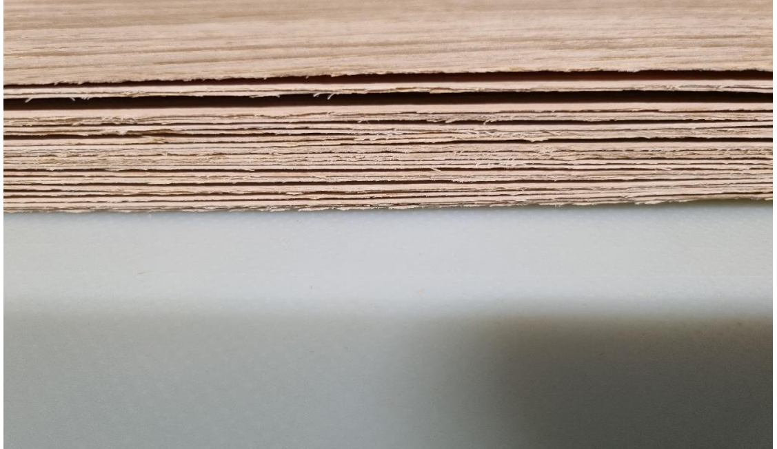
Slika 13. Grub rez noža
