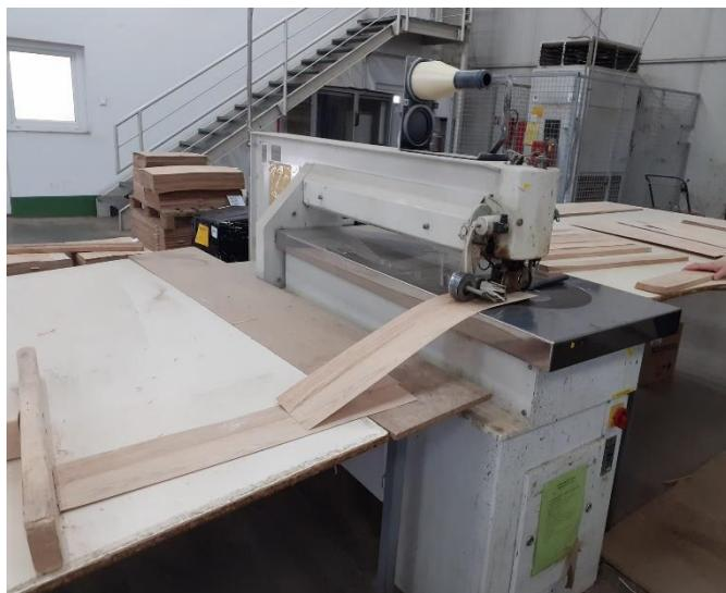
Slika 4a. Stroj za širinsko lijepljenje „cik-cak“
