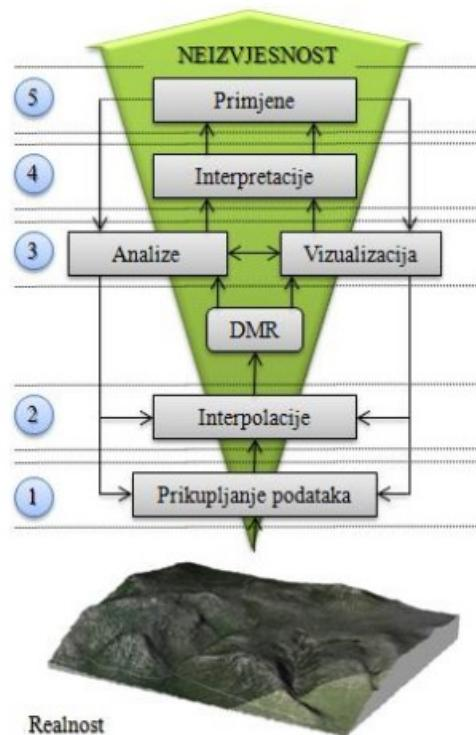
Slika 10 Faze digitalnog modeliranja reljefa
