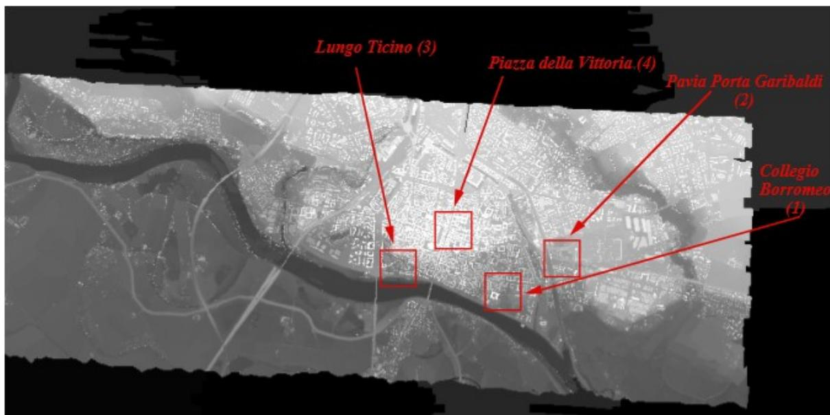
Slika 34 Dvodimenzionalni prikaz LIDAR skupa podataka nad gradom Pavia, sjeverna Italija. Kvadрати predstavljaju četiri ispitna područja korištena za uvježbavanje algoritma za ekstrakciju DTM-a u ovom istraživanju (Izvor: Dell'Acqua, F. i dr.: „Digital terrain models in dense urban areas“)
