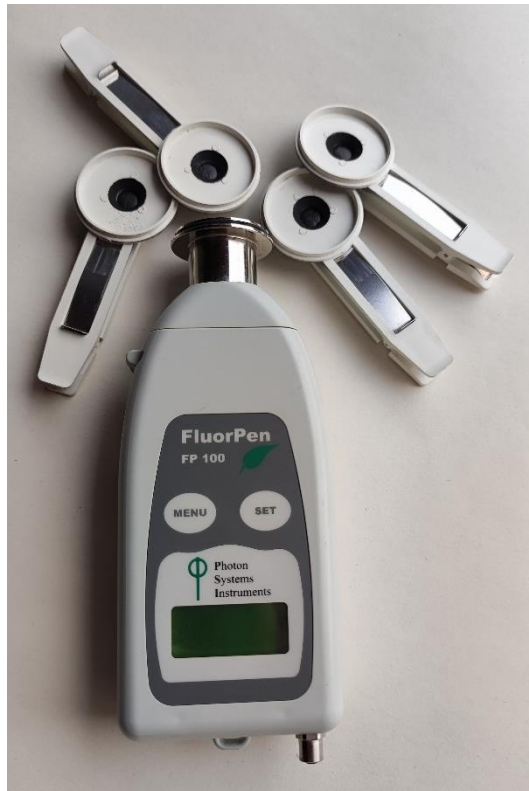
Slika 2. Uređaj FluorPen FP100
