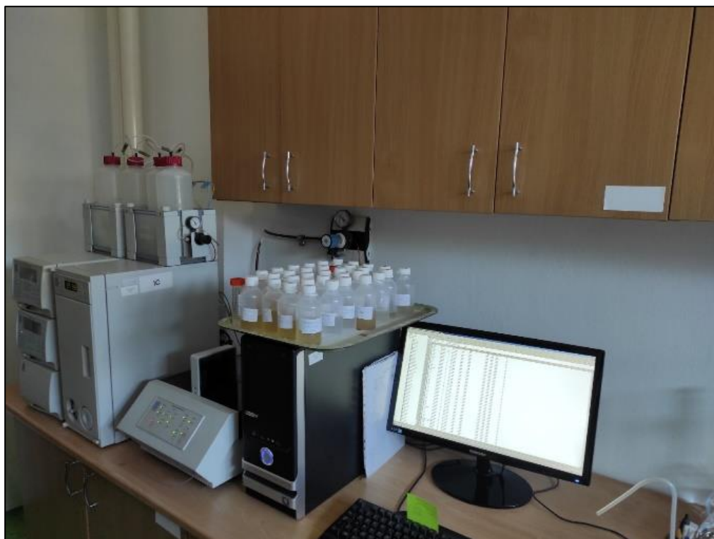
Slika 11. Analiziranje vodenih uzoraka na ionskom kromatografu na Hrvatskom šumarskom institutu u Jastrebarskom
