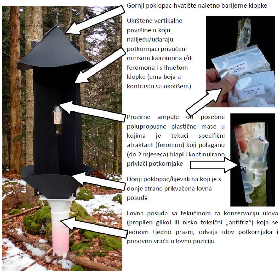
Slika 10 Prikaz WitaPrall klopke i njezinih sastavnih dijelova (izvor: Boris Hrašovec)
