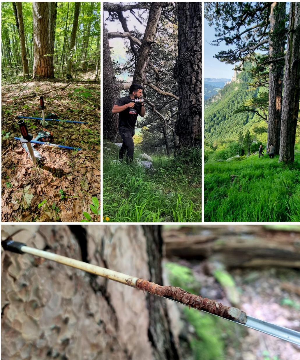
Slika 12. Prikupljanje uzoraka pomoću električne bušilice sa stabala munike i crnoga bora
