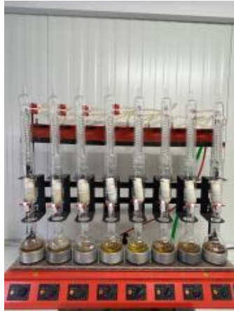
Slika 10. Proces ekstrakcije uzoraka
