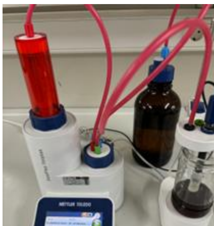
Slika 16. Određivanje OH broja
