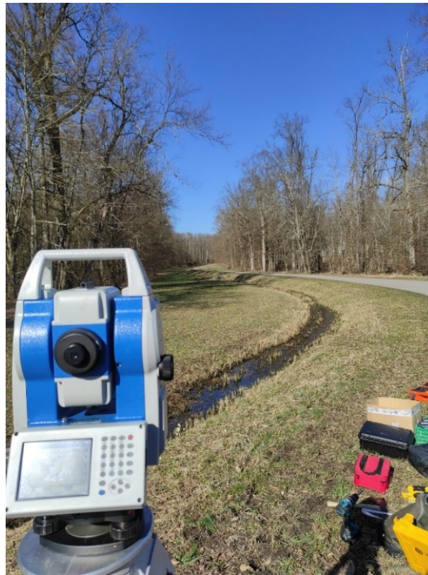
Slika 13. Prikupljanje terenskih podataka totalnom stanicom Stonex R35
