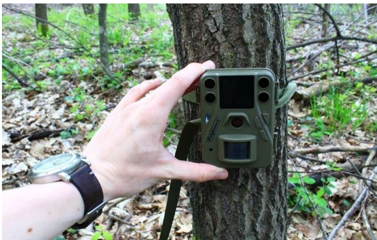
Slika 8. Kamera tvrtke Bolyguard, model SG520 (Foto: Ivan Juraj Čehulić)
