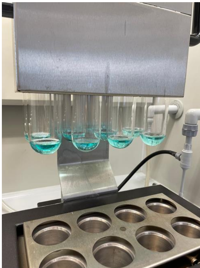
Slika 7. Uzorci maline nakon spaljivanja- blok Foss Labtec TM DT208 Digestor.
