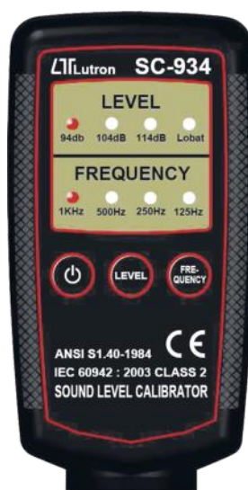
Slika 6: Višefrekventni kalibrator razine zvuka (Izvor: https://www.metroteh.hr/lutron-sc-934 )
