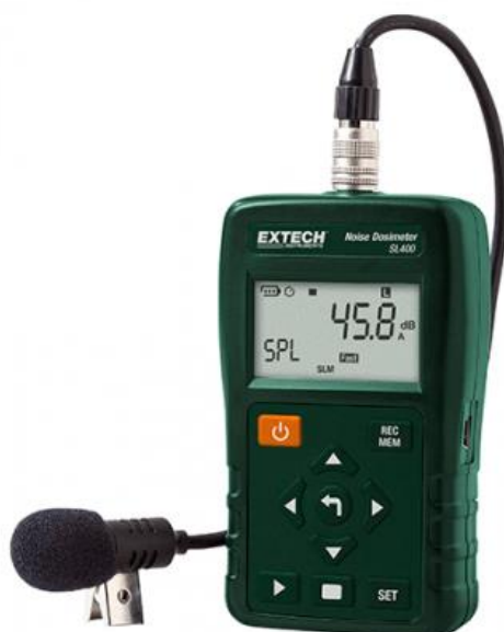
Slika 8: Osobni dozimeter buke (Izvor: https://www.metroteh.hr/extech-sl-400 )
