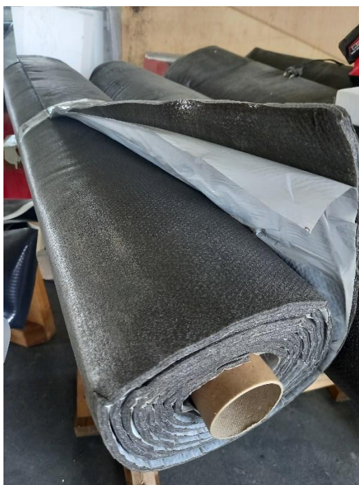
Slika 20: Spužvasti polietilen sa olovnom pločom
