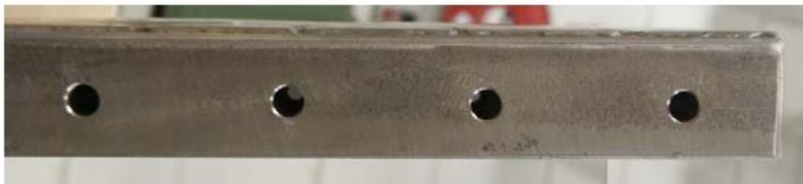
Slika 30. Rupe za izlaz vodene pare na metalnim ograničavajućim letvicama (Sandberg i Johansson,2005)
