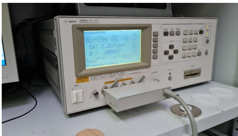
Slika 38. Prikaz Agilent 4285 A LCR mjerača električnih svojstava
