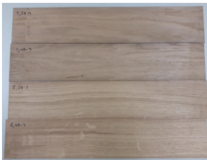
Slika 36. Primjer hrastovih lamela korištenih u eksperimentu ( prve dvije lamele su tangentnoga presjeka, dok su druge dvije radijalnoga presjeka )
