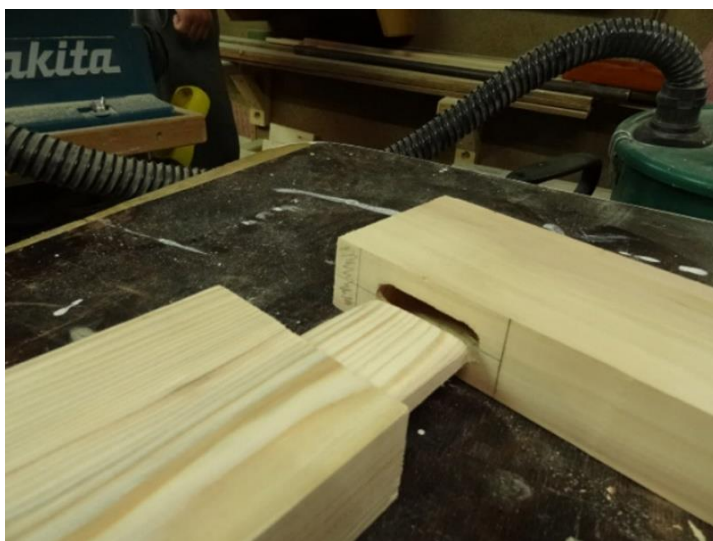
Slika 10: Čep u podužnoj rupi
