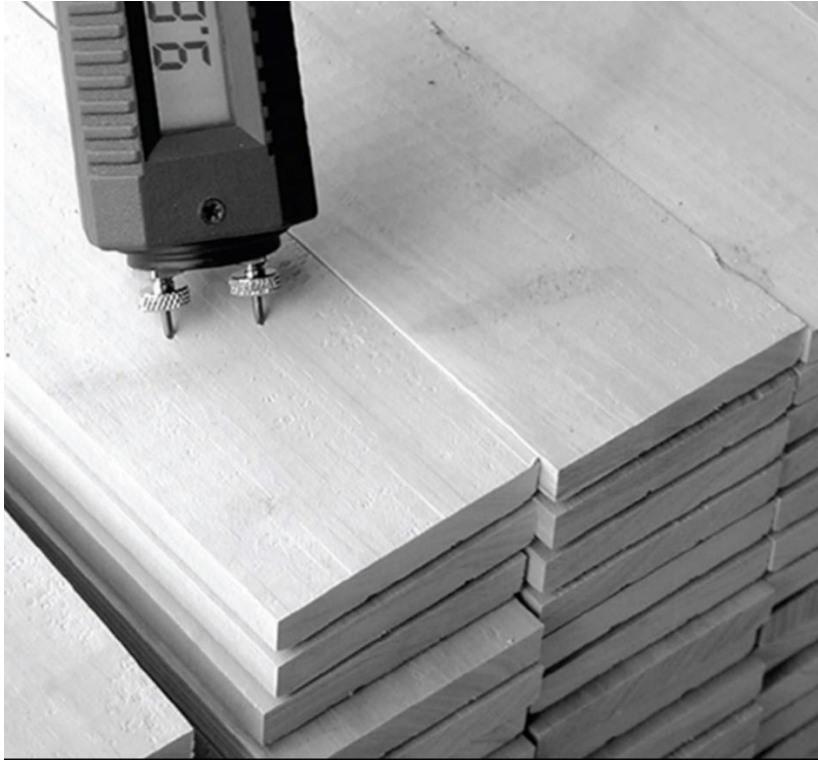
Slika 8: Električni vlagomjer za drvo
