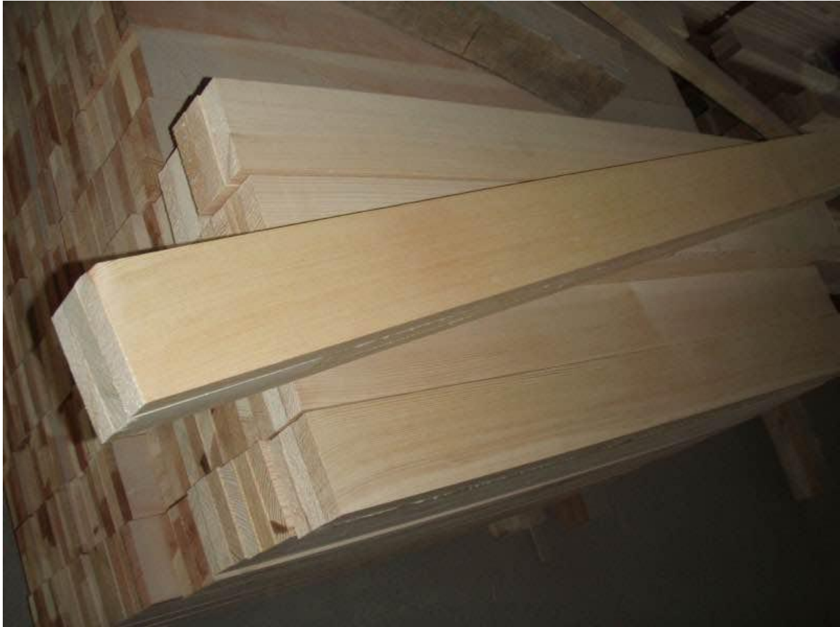
Slika 6: Gotovi lamelirani elementi
