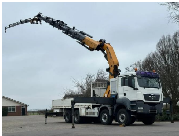
Slika 16. Kamion sa kranom i aktivnim bočnim stabilizatorima Izvor: https://www.truck1.hr/kamioni/kamioni-s-kranom/man-tga-26-440-6x4x4-h-pm-35527-fly-jib-crane-kran-a8204029.html (Pristupljeno 19.9.2024.)
