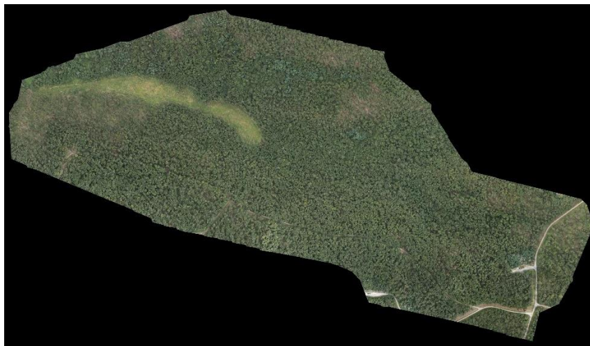
Slika 6. DOF (jedan segment) nastao snimanjem bespilotnom letjelicom i obradom u programu DJI Terra
