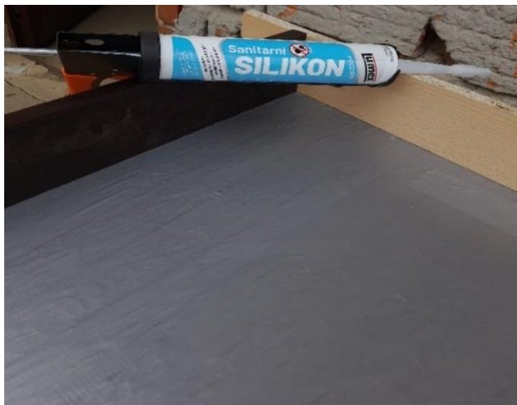
Slika 9. Silikon za zatvaranje rubova kalupa
