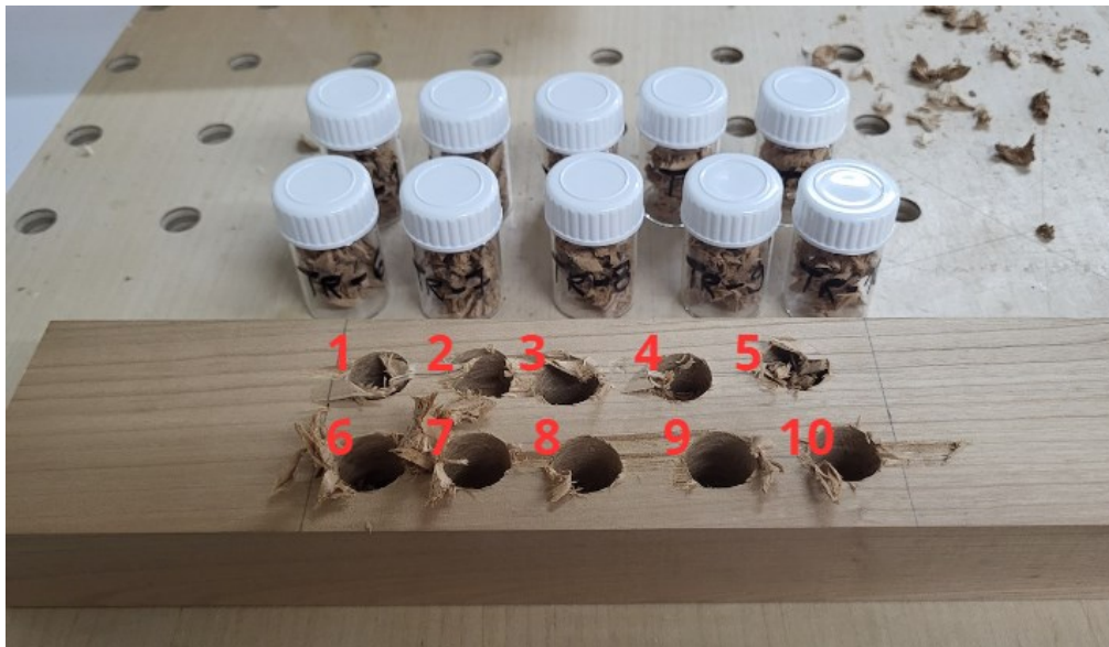
Slika 18. Prikaz mjesta uzorkovanja strugotine (foto:Ivanda A., 2024.)
