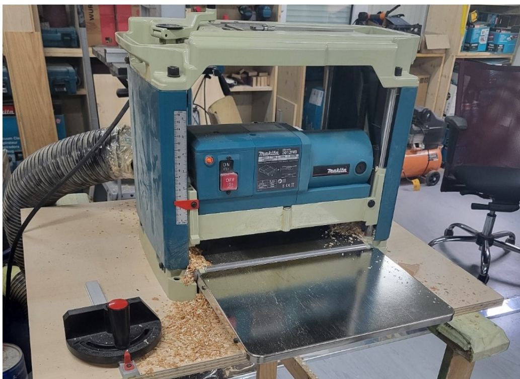
Slika 8. Blanjalica u stolarskoj radionici Fakulteta (foto:Ivanda A., 2024.)
