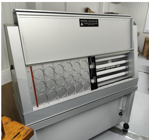
Slika 25. Uređaj za ubrzano UV izlaganje
