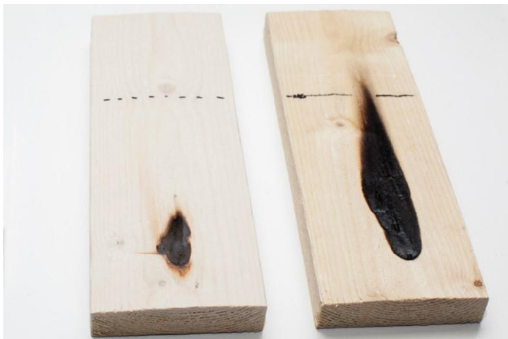
Slika 4. Prikaz usporedbe zaštićenog uzorka i nezaštićenog uzorka vatrootpornim sredstvom.
