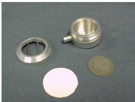
Slika 3.4 Držač filtra za sakupljanje ukupne prašine
