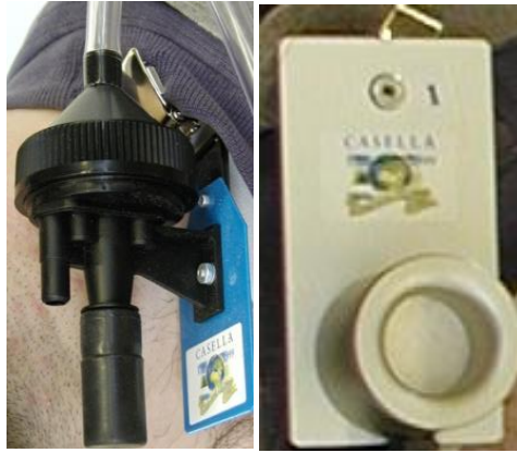
Slika 3.6 Držač filtera respirabilne frakcije i ukupne prašine
