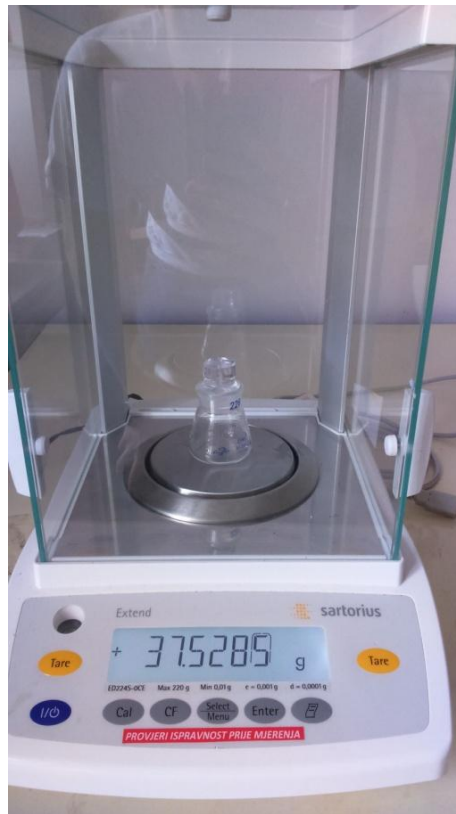
Slika 7. Mjerenje mase praznog piknometra
