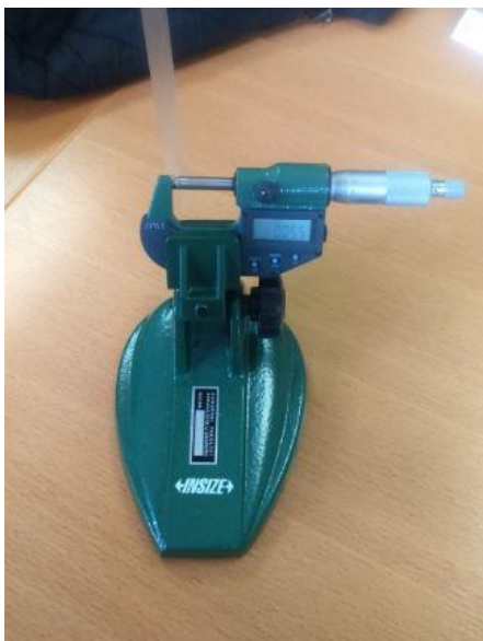
Slika 11. Mjerenje debljine suhog filma pomoću mikrometra
