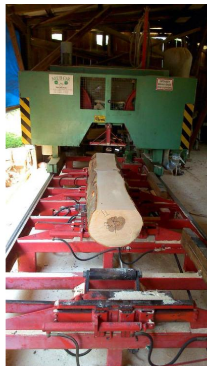
Slika 10. Tračna pila trupčara
