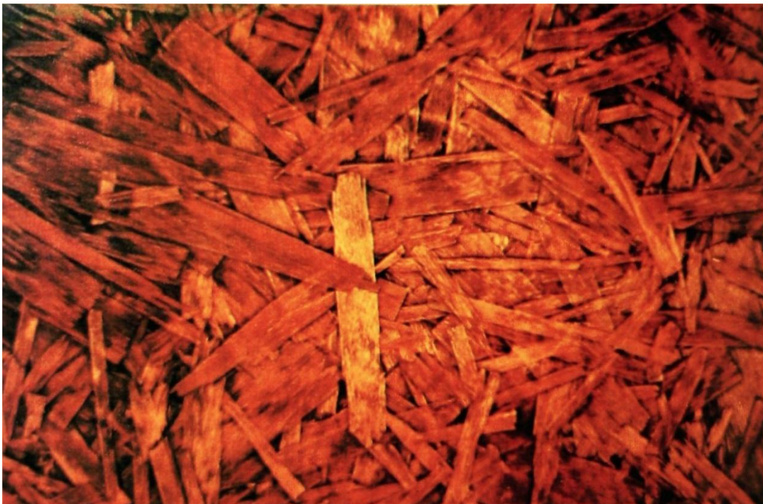
Slika 3: Dekorativna ploča izrađena od iverja bojanog sa orahovim bojilom
