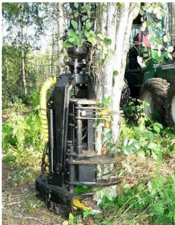
Slika 3. Harvesterska glava za pridobivanje energetskeg drva (Izvor: Križanić 2013).
