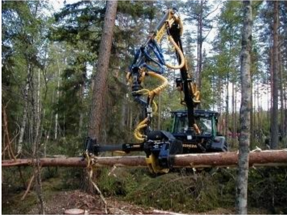
Slika 4. Harvesterska glava s taktnom tehnologijom (Izvor: Uusitalo 2010).
