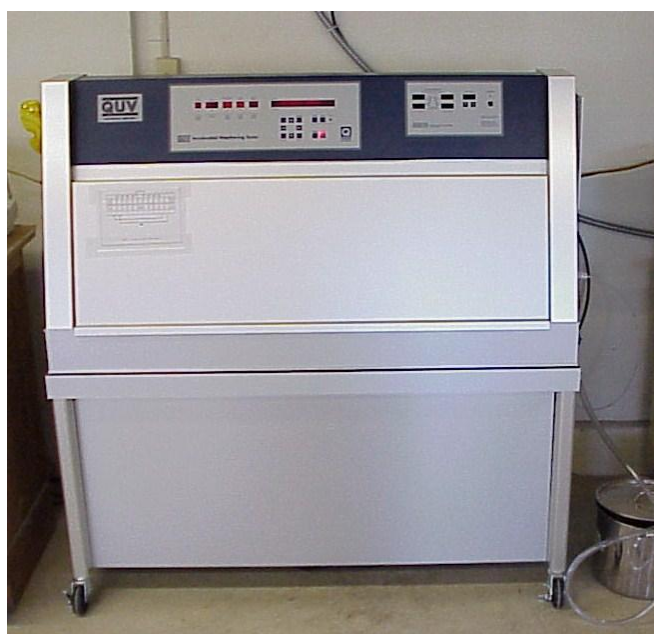
Slika 8. QUV uređaj za ubrzano izlaganje
