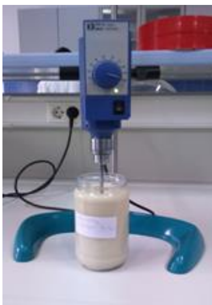
Slika 6. Dispergiranje nanočestica u premaz
