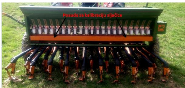
Slika 20. Posuda za kalibraciju sijačice
