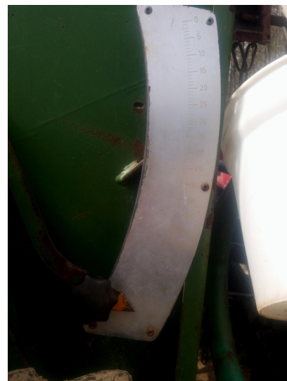
Slika 19. Poluga za namještanje propusnosti sjemena sijačice
