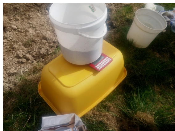
Slika 21. Vaganje sjemena iz kalibracijske posude sijačice
