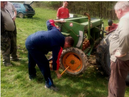
Slika 18. Provjera propusnosti sijačice na zadanu površinu
