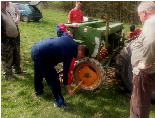
Slika 18. Provjera propusnosti sijačice na zadanu površinu
