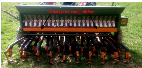
Slika 20. Posuda za kalibraciju sijačice
