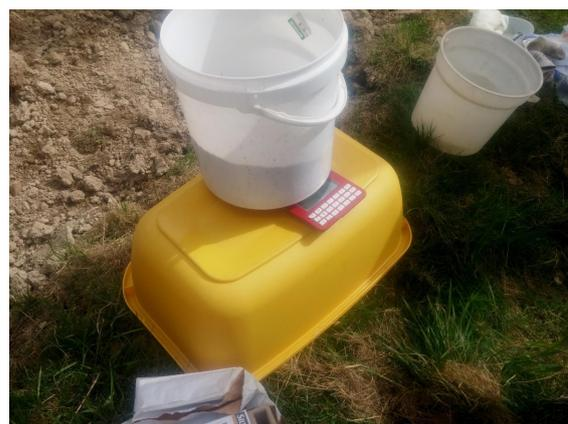
Slika 21. Vaganje sjemena iz kalibracijske posude sijačice
