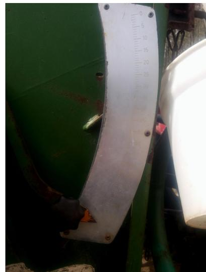
Slika 19. Poluga za namještavanje propusnosti sjemena sijačice
