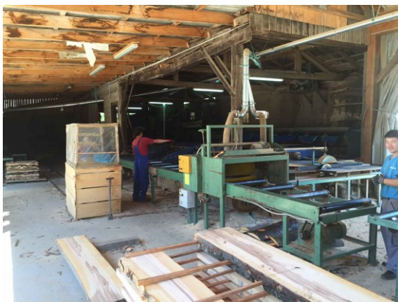
Slika 18. Čistač rezane građe prije slaganja u palete
