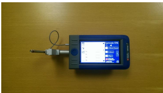
Slika 15. Instrument za mjerenje hrapavosti površine
