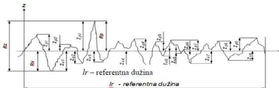
Graf 4. Grafički prikaz parametra hrapavosti R_z (Runje, 2014.)
