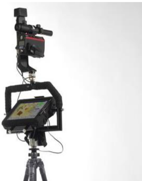
Slika 4. FieldMAP sustav za inventarizaciju šuma
