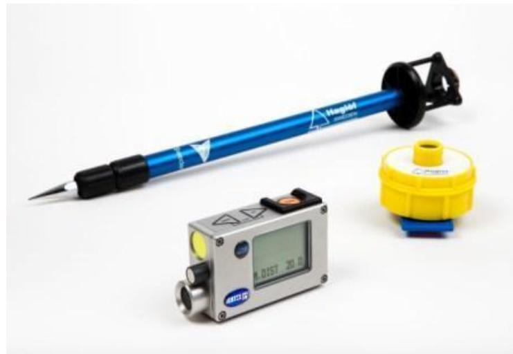
Slika 2. Dijelovi Verteks-a
