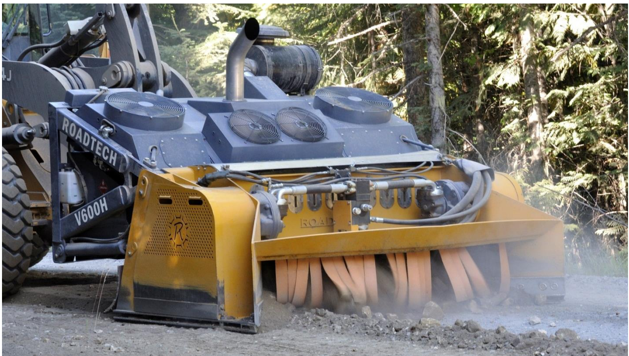
Slika 4. Metoda popravka kolnika drobljenjem kamenog materijala
