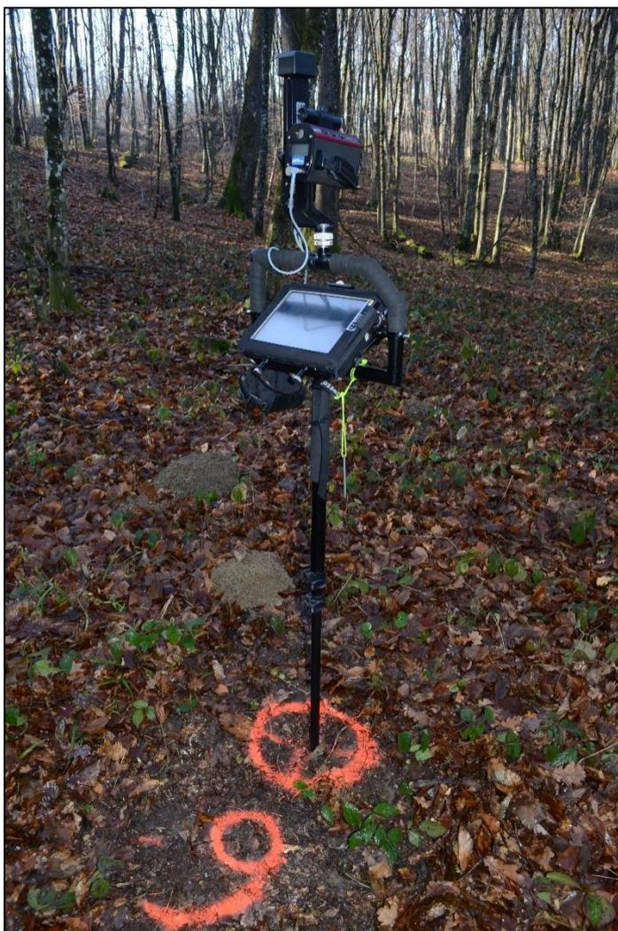
Slika 15. Prikaz izmjere korištenjem Field-Map uređaja.
