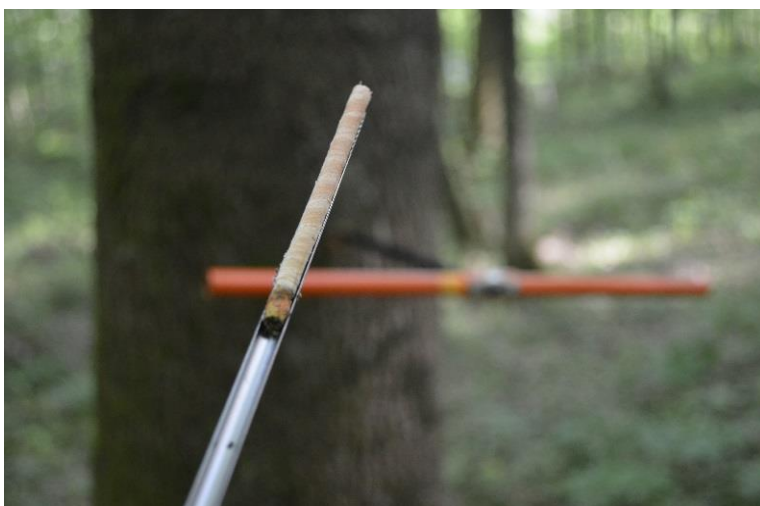
Slika 17. Uzimanje izvrtaka iz stabala glavnih vrsta drveća.
