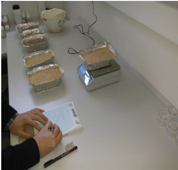
Slika 23. Vaganje uzoraka prije sušenja
