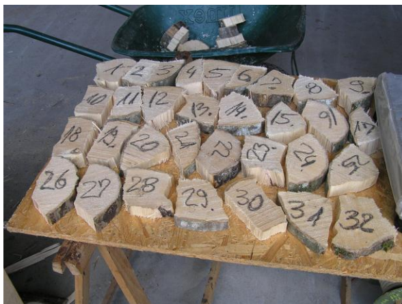
Slika 29. Uzorci iz cjepanica za potrebe mjerenja vlage gravimetrijskom metodom
