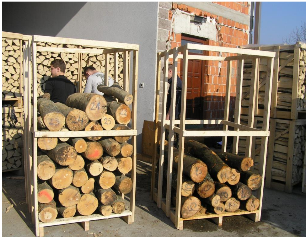
Slika 32. Složena paleta s uzorcima oblice metrice u postupku mjerenja
