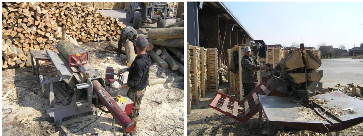
Slika 19. Cijepanje metrice horizontalnim hidrauličnim cjepačem
