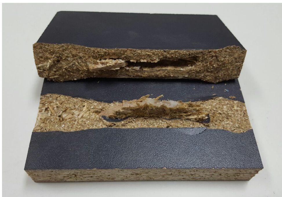
Slika 47. Uzorak L-IT nakon ispitivanja izvlačne čvrstoće
