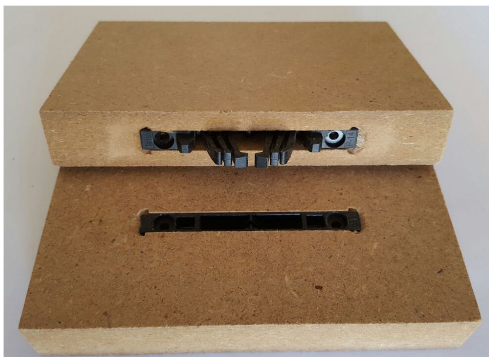
Slika 50. Uzorak T-MDF nakon ispitivanja izvlačne čvrstoće
