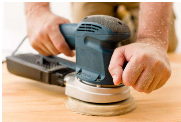
Slika 9 – Prikaz brušenja drva ručnom kružnom brusilicom
