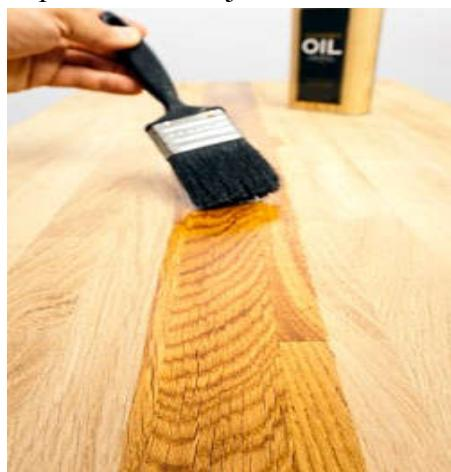
*Slika 10 – Prikaz nanošenja ulja kistom
