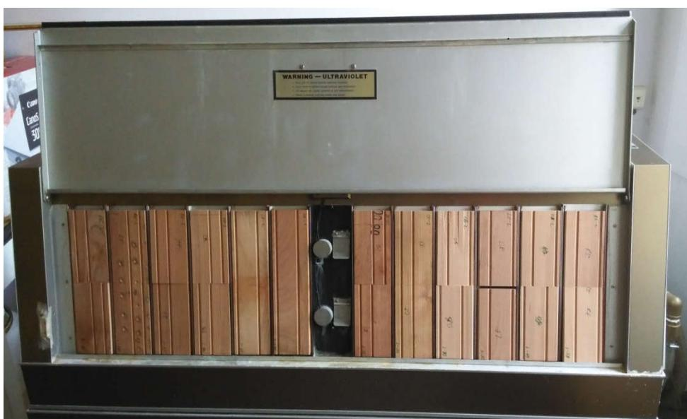
*Slika 23 – Prikaz QUV uređaja i načina slaganja uzoraka*
