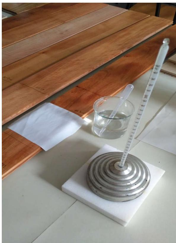
*Slika 13 – Prikaz ispitivanja otpornosti površine prema topolini bez vlage*
