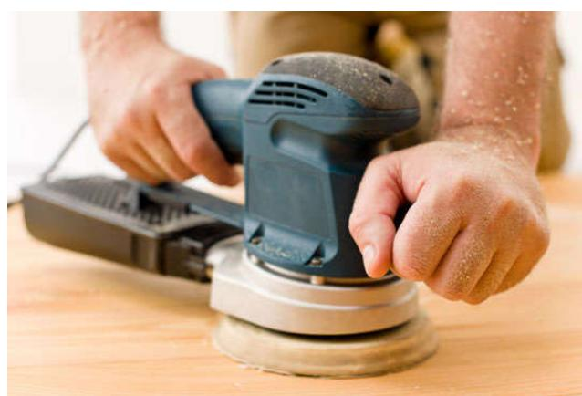
Slika 9 – Prikaz brušenja drva ručnom kružnom brusilicom
