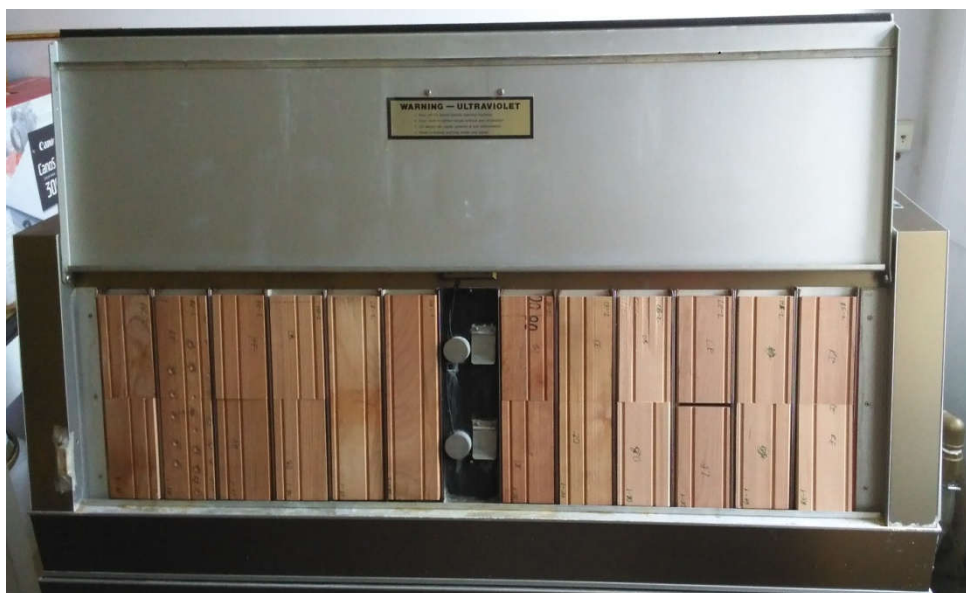
Slika 23 – Prikaz QUV uređaja i načina slaganja uzoraka
