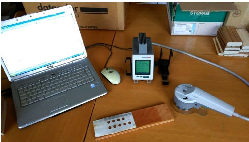
Slika 16 – Prikaz opreme za mjerenje boje
