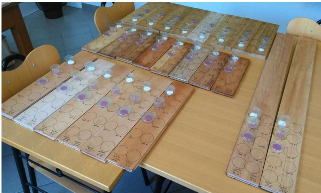
*Slika 14 – Prikaz ispitivanja otpornosti površine prema hladnim tekućinama*
