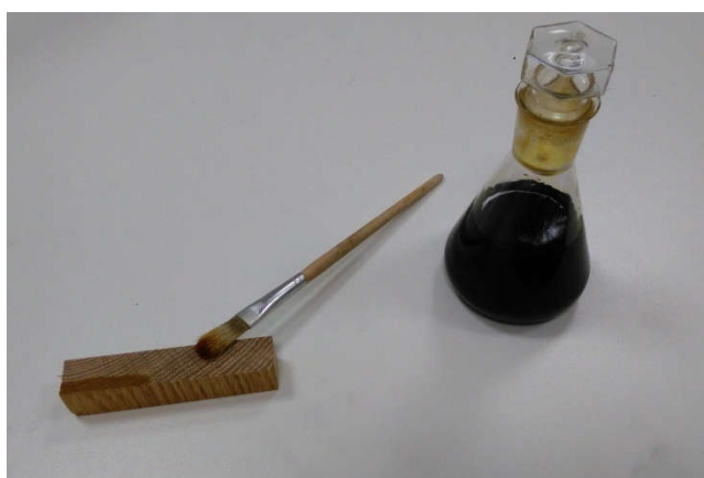
Slika 22 – Prikaz načina nanošenja otopine joda na uzorak za određivanje penetracije
