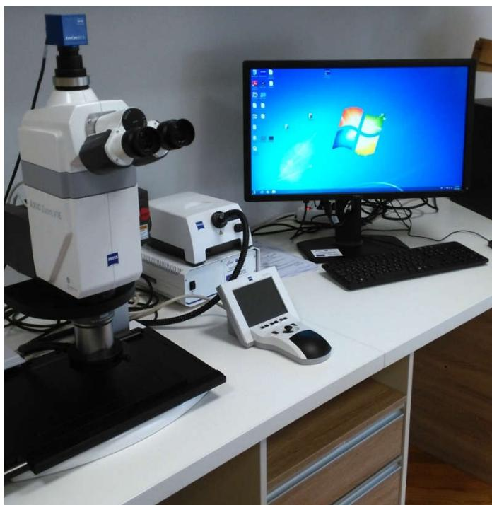
*Slika 21 – Prikaz opreme korištene za određivanje dubine penetracije*
