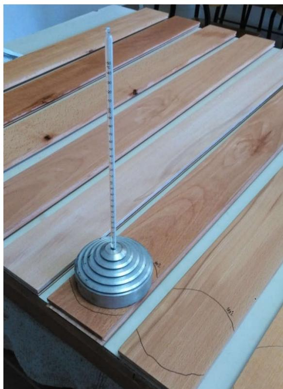
*Slika 12 – Prikaz ispitivanja otpornosti površine prema topolini bez vlage*
