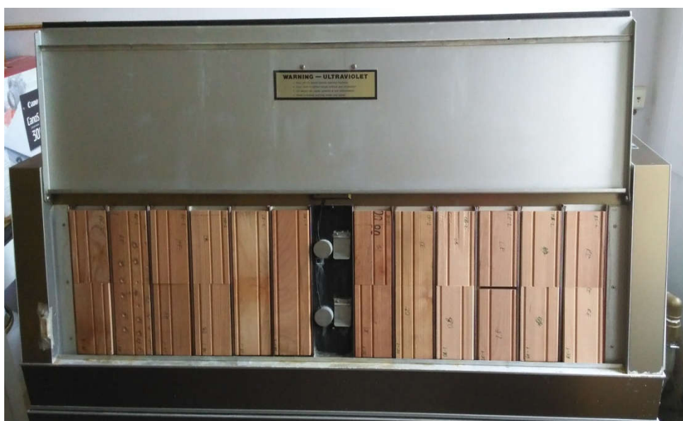
Slika 23 – Prikaz QUV uređaja i načina slaganja uzoraka
