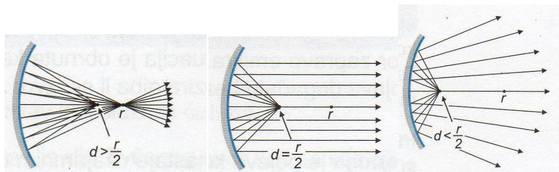
Slika 12 Odbijanje zvuka o konkavni oblik materijala: 1. usnopljavanje, 2. paralelnost, 3. raspršenje (Šimunić)
