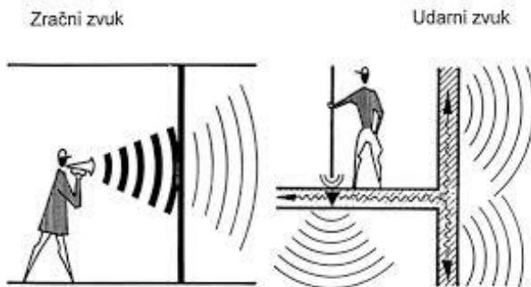
Slika 6 Prenošenje zračnog i udarnog zvuka iz prostorije u prostoriju (Veršić, 2014.)
