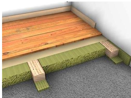
Slika 8 Primjer konstrukcije "plivajućeg" poda (Knauf Insulation, 2010.)
