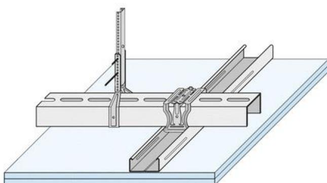
Slika 7 Konstrukcija spuštenog stropa (Daemmen und sanieren)
