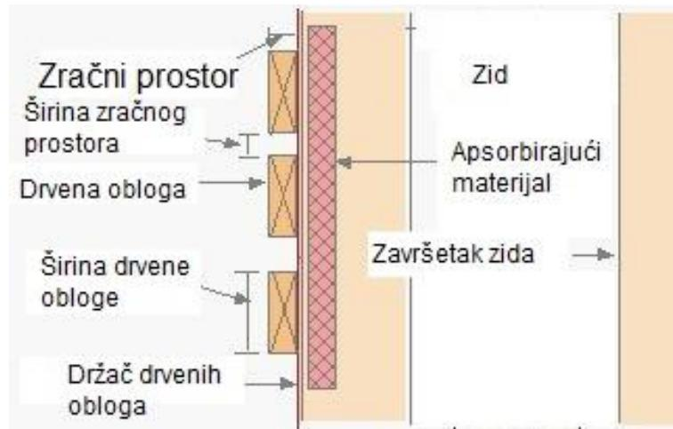
Slika 10 Bokocrtni presjek zida s drvenim pločama koje služe kao rezonantori
