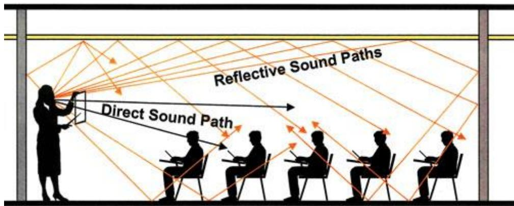
Slika 2 Smjerovi direktnog i reflektirajućeg zvuka (Arsenault)
