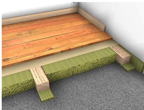
Slika 8 Primjer konstrukcije "plivajućeg" poda (Knauf Insulation, 2010.)
