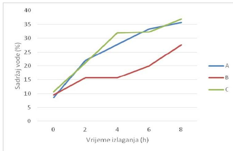
**Slika 6.** Grafički prikaz rezultata ispitivanja sadržaja vode uzorka OSB ploče
