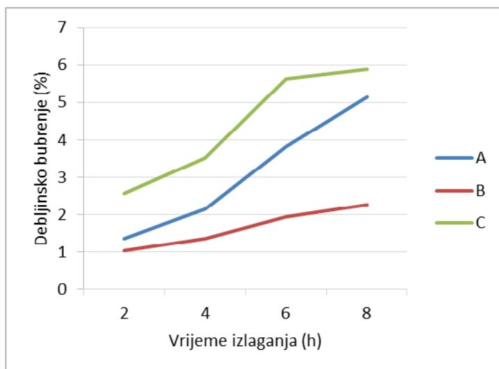
**Slika 9.** Grafički prikaz rezultata ispitivanja debljinskog bubrenja uzorka OSB ploče
