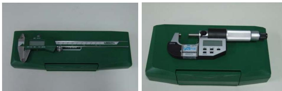
**Slika 3.** Digitalno pomično mjerilo i mikrometar
