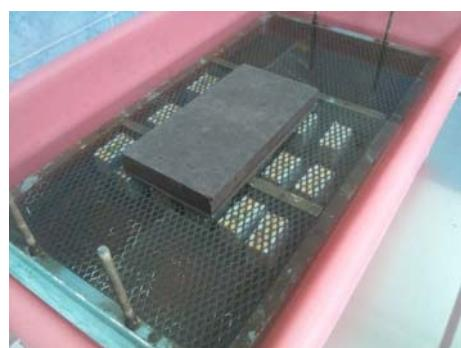
**Slika 4.** Tretman uzorka u priručnoj vodenoj kupelji
