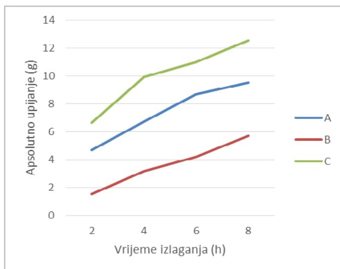
**Slika 7.** Grafički prikaz rezultata ispitivanja absolutnog upijanja vode uzorka OSB ploče
