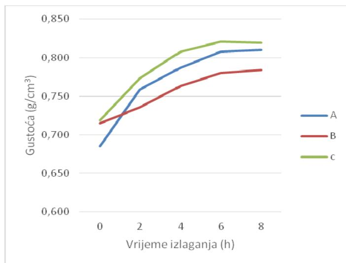
**Slika 5.** Grafički prikaz rezultata ispitivanja gustoće uzorka OSB ploče
