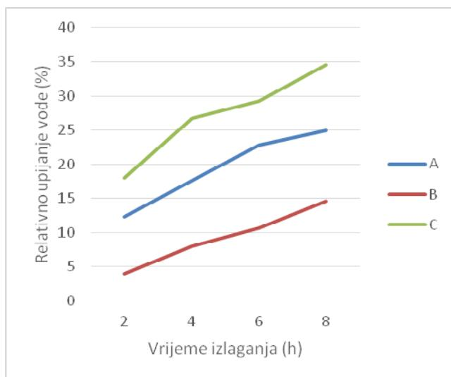
**Slika 8.** Grafički prikaz rezultata ispitivanja relativnog upijanja vode uzorka OSB ploče
