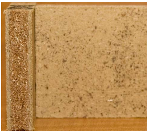
Slika 2. Uzorak proizvedene mješovite ploče (drvena vlakanca u vanjskom sloju i unutarnji dijelovi kore bijele breze u srednjem sloju)
