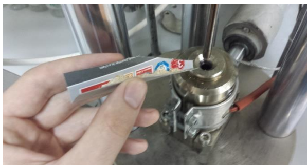
(slika 21.; doziranje pripremljene drvene sirovine u prešu)
