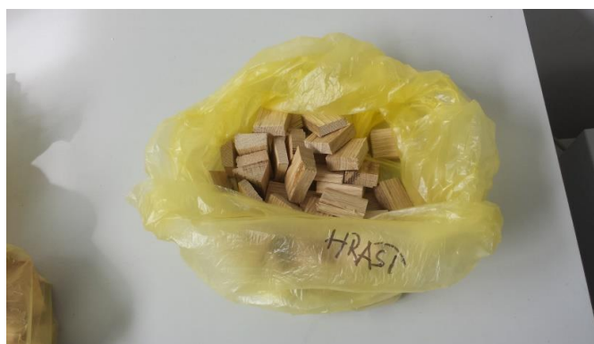
(slika 10.; uzorci hrasta nakon usitnjavanja pomoću dlijeta i čekića)
