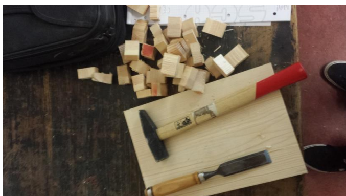
(slika 9.; usitnjavanje uzoraka pomoću dlijeta i čekića)
