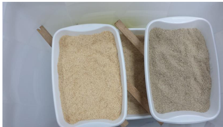
(slika 15.; kondicioniranje uzoraka usitnjenog drva)
