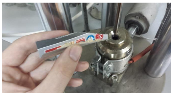
(slika 21.; doziranje pripremljene drvene sirovine u prešu)
