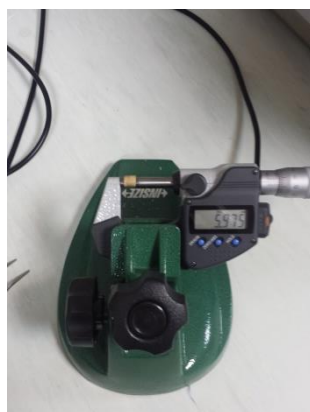
(slika 23.; mjerenje dimenzija peleta)
