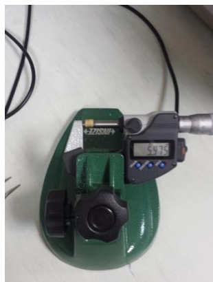
(slika 23.; mjerenje dimenzija peleta)
