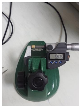
(slika 23.; mjerenje dimenzija peleta)
