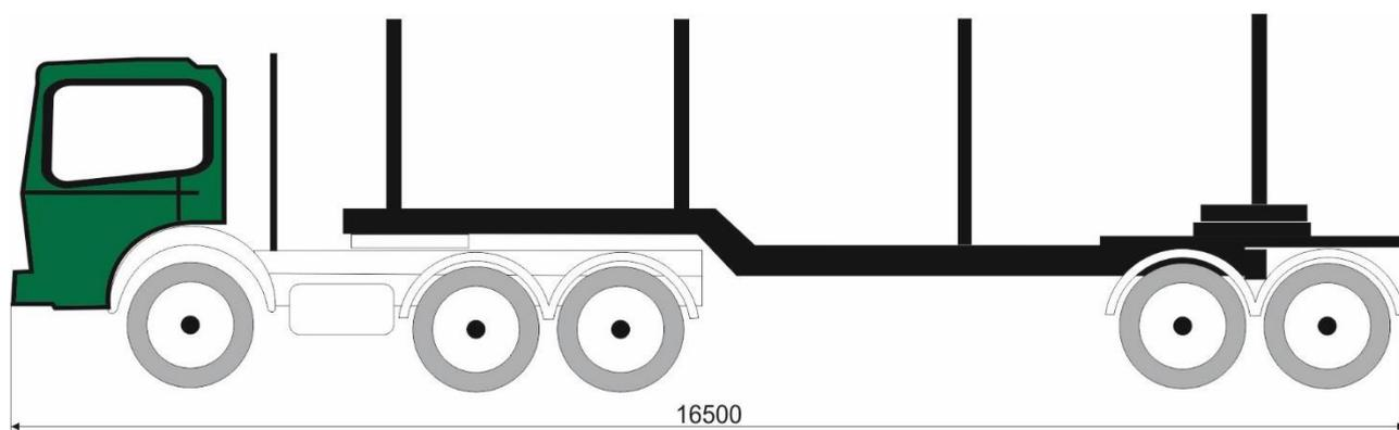
Slika 84. Dimenzije šumskog tegljačkog skupa bez ugrađene hidraulične dizalice
