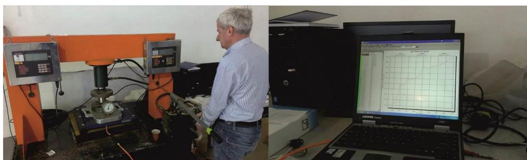
Slika 34. Umjeravanje prijenosnog mjernog sustava
