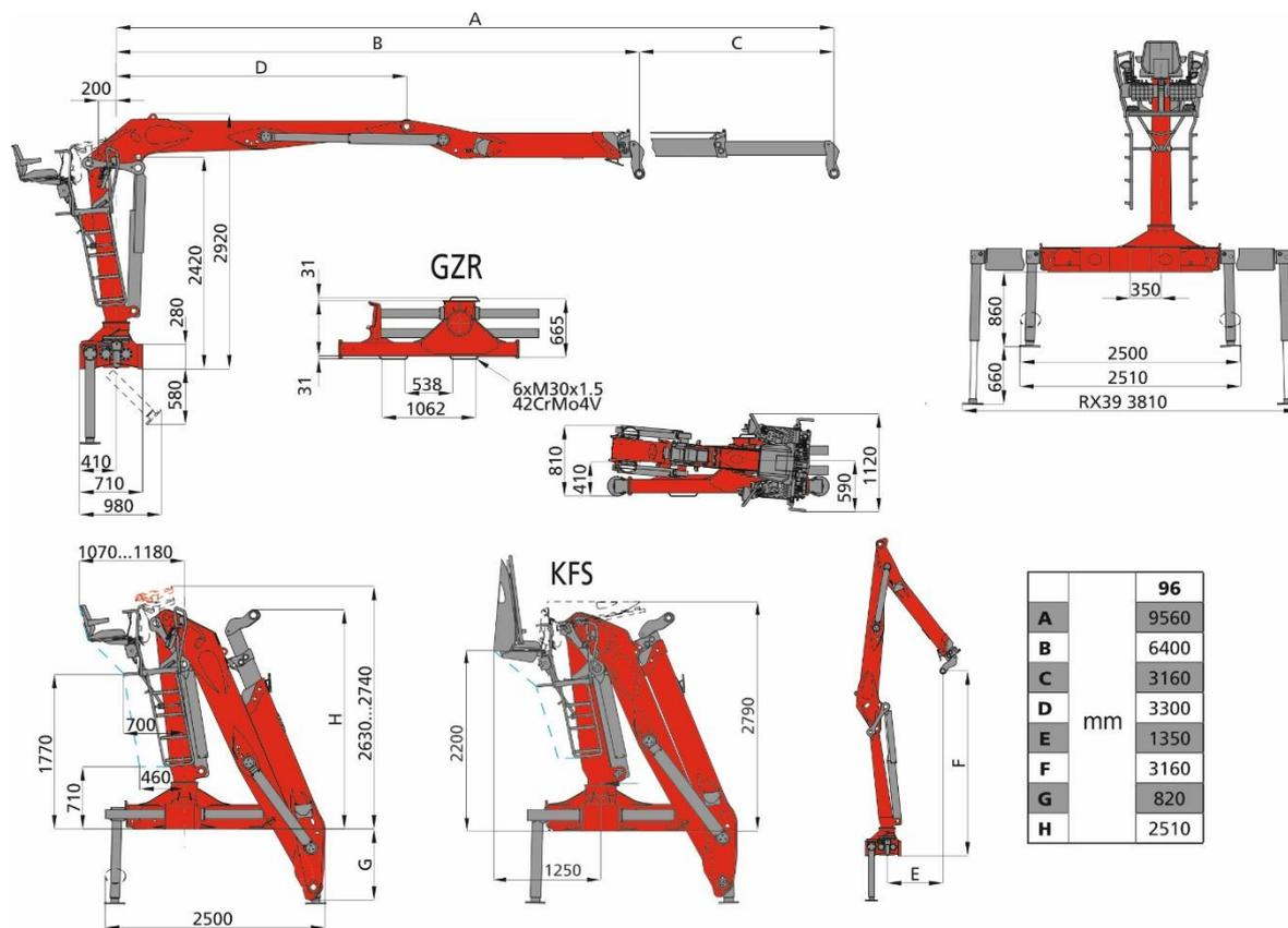
Slika 27. Dimenzije hidraulične dizalice Epsilon Palfinger M110Z
