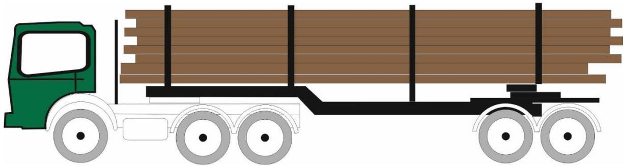
Slika 6. Šumskim kamionskim skupom sa tegljačkom dvoosovinskom prikolicom, bez hidraulične dizalice
