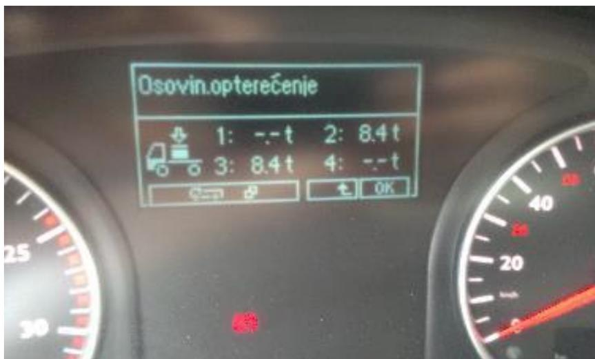
Slika 39. Prikaz izmjerenih osovinskih opterećenja u kabini kamiona
