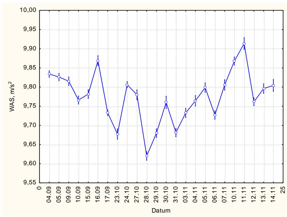
Slika 100. Analiza varijance mjerenja vibracija tokom 24 radna dana
