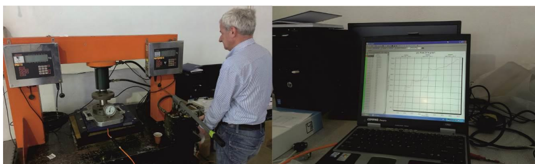
Slika 34. Umjeravanje prijenosnog mjernog sustava
