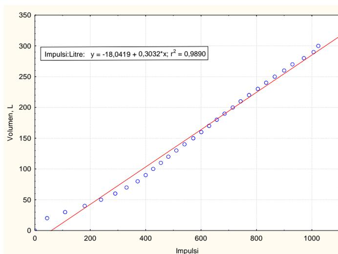
Slika 52. Dijagram umjeravanja sonde za mjerenje razine goriva
