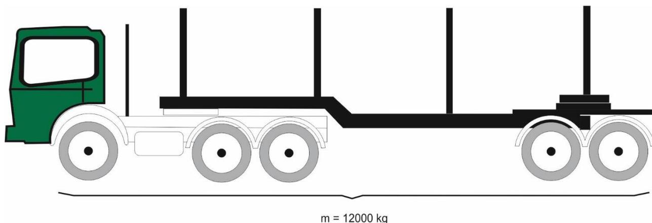
Slika 85. Masa šumskog tegljačkog skupa bez ugrađene hidraulične dizalice
