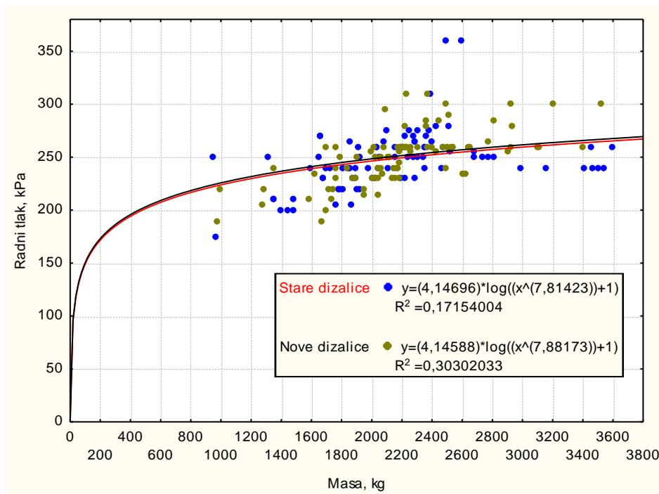
Slika 63. Ovisnost radnog tlaka o masi dizalice
