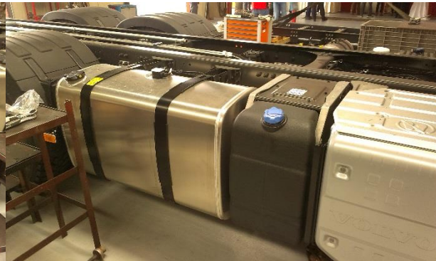
Slika 83. Opremanje kamiona aluminijskim spremnikom za gorivo
