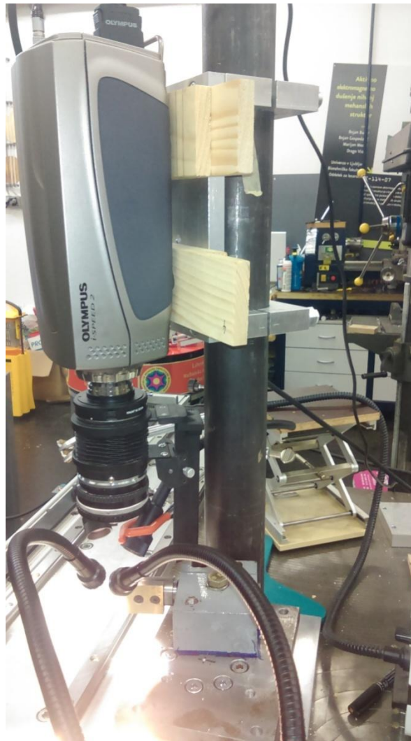
Slika 7.9. Kamera Olympus I – SPEED 2 s objektivima pričvršćena iznad oštrice alata s halogenom rasvjetom
